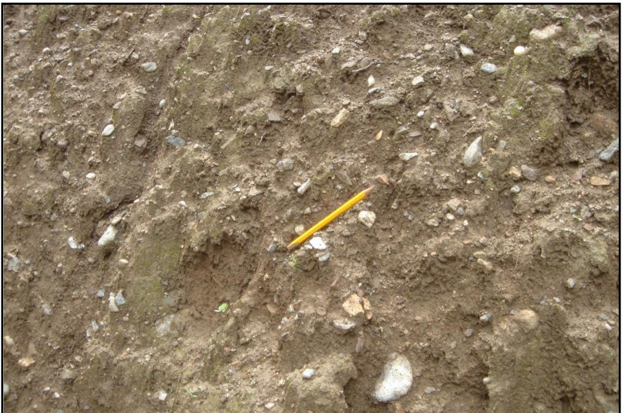
*foto 41 – deposito di versante: detriti annegati in matrice limo-argillosa in loc. Folla*
